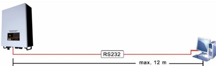
Рис. 54. RS232 Схема связи
