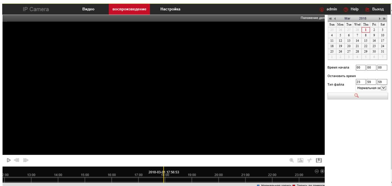
Здесь вы можете получить доступ файлам на SD карте в соответствии с типом записи (обычная запись, запись по тревоге) и времени записи.
