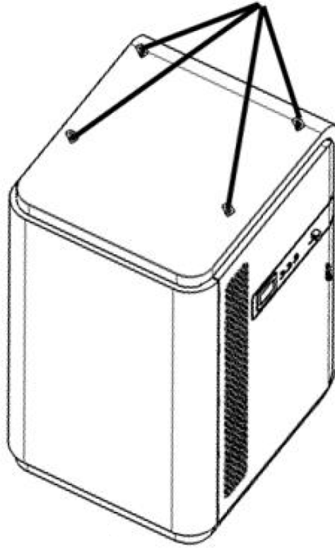
Зображення 15: Схема положення при підйомі краном
