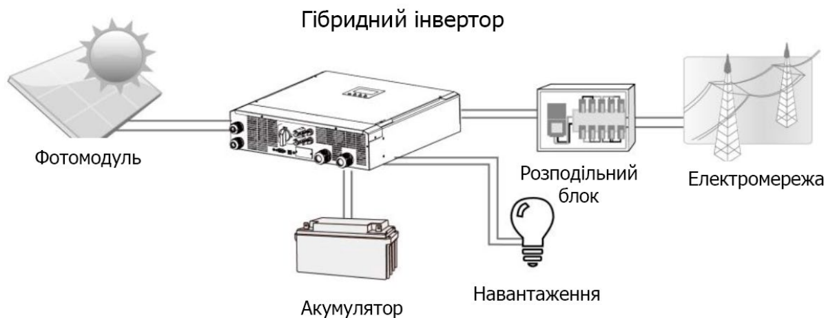
Рисунок 1 Огляд базової гібридної сонячної системи
