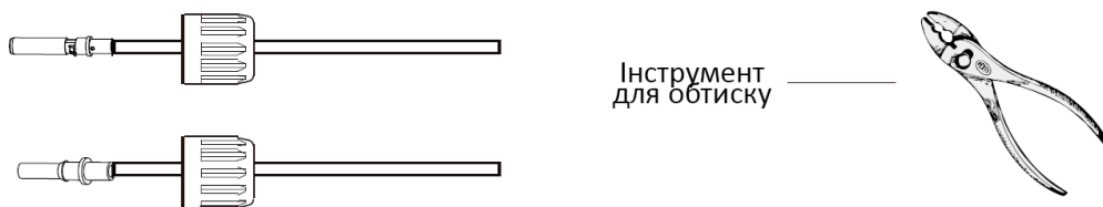
Рис. 3.4 Закріплення контактної штифту на дрiт
