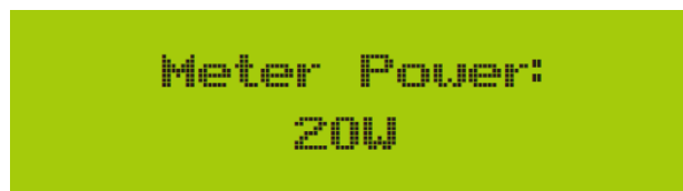
Зображення 7.36 Увімкнення функції нульового експорту через лічильник
